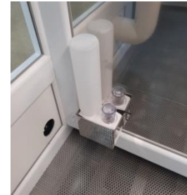
Fig. 6 Pulverizatorul de dezinfectant cu ultrasunet
